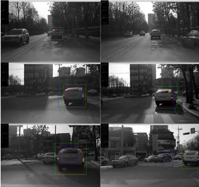
그림 4. 차량 블랙박스 영상에 대해 본 논문 결과와 IVT 그리고 ground truth 를 윈도우로 나타낸 그림. 빨간색 윈도우는 ground truth 를 나타내고, 파란색은 IVT 결과를 그리고 초록색 윈도우는 본 논문에서 제안하는 방법의 결과를 나타냄.
